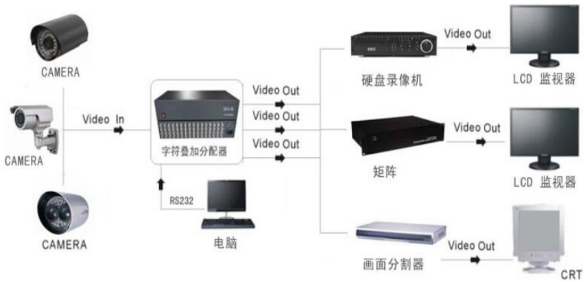
静态字符叠加器连接示意图
